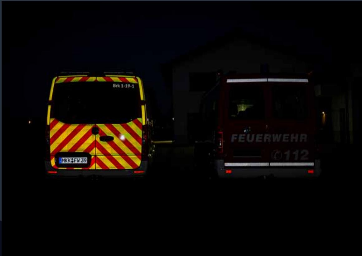
*Die Beklebung ist einer der größten Unterschiede zwischen der neuen (links) und alten Fahrzeuggeneration (rechts). Beim Anleuchten lässt sich nun die Fläche des Fahrzeuges, der Funkrufname sowie der Schriftzug „Feuerwehr“ viel deutlicher erkennen. Am Heck des Fahrzeuges sorgt die neue Heckwarnbeklebung für eine erhebliche Verbesserung bei der Warnwirkung.*
